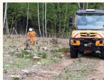
Schlauchbewässerung mit 2.000l Tank mit Stromaggregat und Tauchpumpe von der Rückegasse aus
