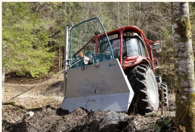
Die Pfanzelt S160 zeichnet sich durch einen niedrigen Seileinlauf und eine übersichtliche Bauform aus.
